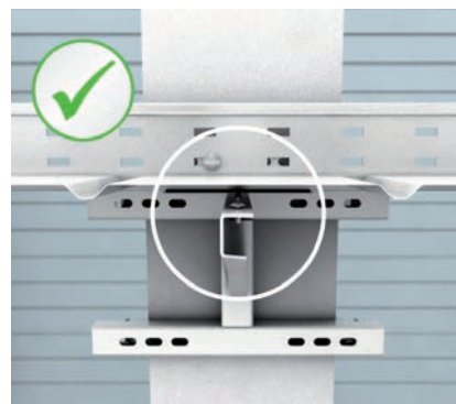
3 | Установка лотка на консоль Правильно: Консоль должна находиться между ребрами жесткости дна лотка.
